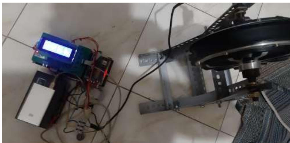
Gambar 2. Integrasi dan Pengujian Sistem Kontrol Motor BLDC
