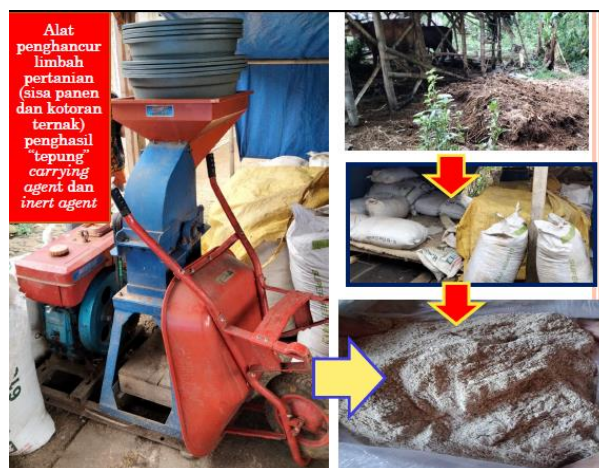
Gambar 4. Alat penghancur sekam dan kotoran ternak hingga dihasilkan tepung sekam (kanan bawah) yang dijadikan sebagai bahan pembawa dan innert agent biofertilizer
